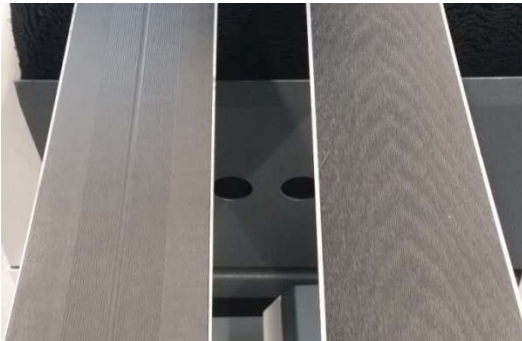
Bild 2: Links: Linear durchlaufende Riefen. Rechts: Unterbrochene Riefen.
