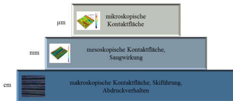
Bild 8: Einflüsse und Größenskala des Skischliffs.
