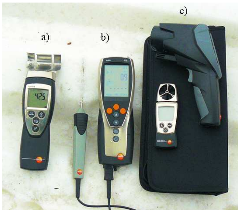
Bild 2: Geräte zur Messung von Schneefeuchte a) und Schneetemperatur. b) Einstichthermometer; c) Infrarotthermometer.
